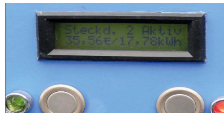
Die Ladesäule zeigt an, welche Steckdose in Betrieb ist, wie viel Euro zu bezahlen sind und welche Energiemenge geladen wurde.
